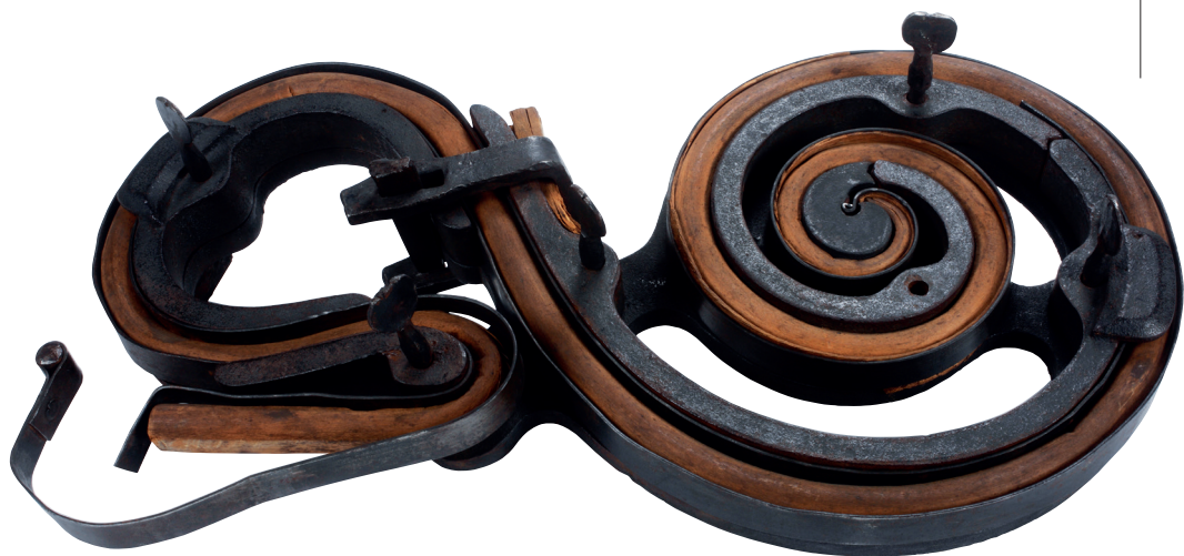
PRESSVORRICHTUNG für Bugholz-Kanapeeschnörkel, um 1900, Inv.Nr. 53908
