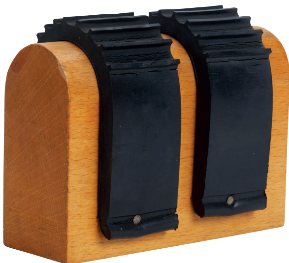
ERMÜDUNGSPROBE aus Naturkautschuk und Buna, um 1929–1940, Inv.Nr. 80593/1
