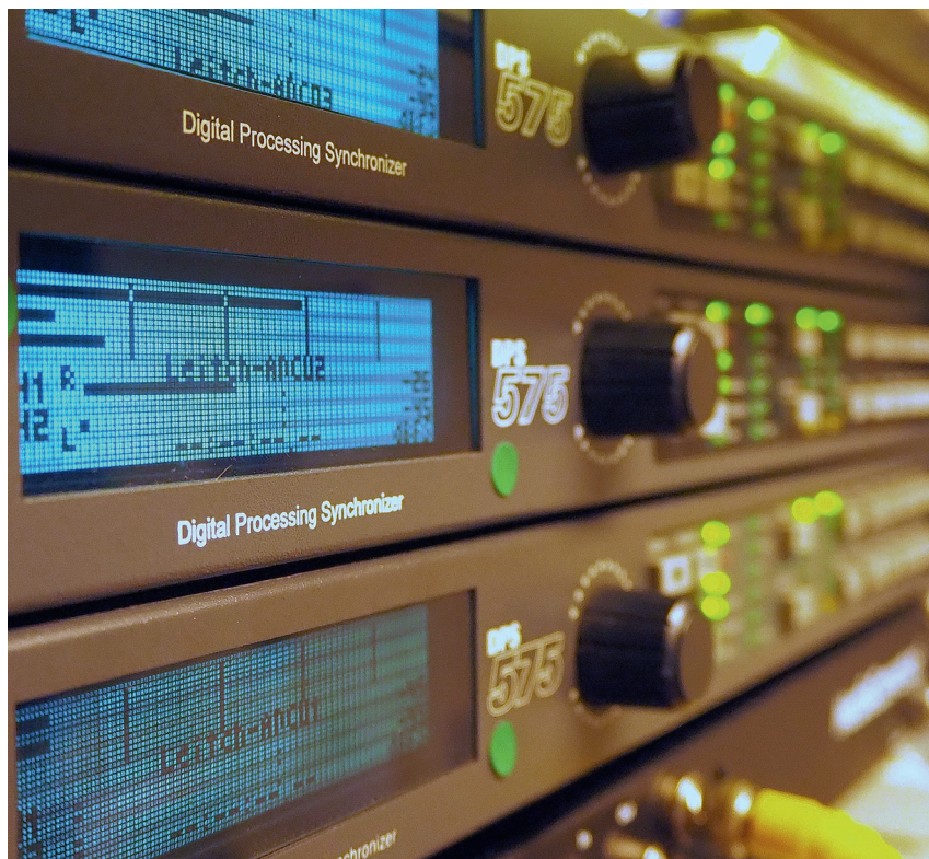
Analog/Digital-Signalwandler im Videobereich, Leitch DPS 575, © Österreichische Mediathek, Rainer Hubert
