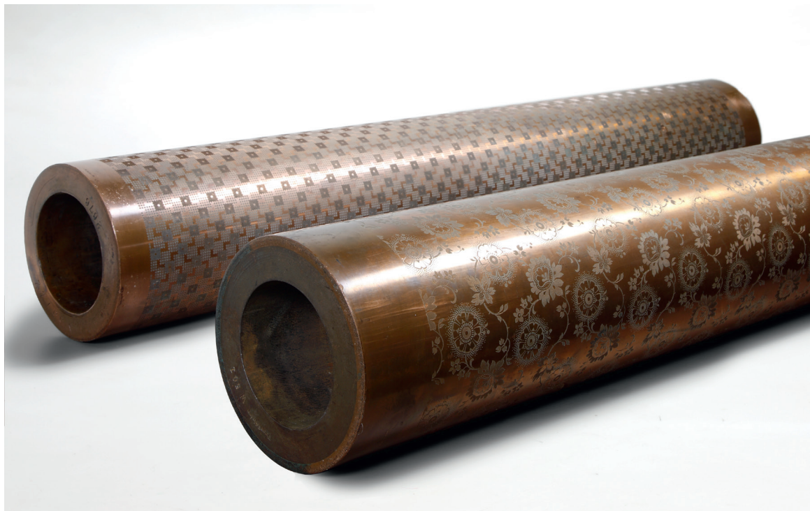
7 KUPFERWALZE und WALZE AUS KUPFER UND EISEN für Textildruckereien, vor 1914 bzw. 1916
