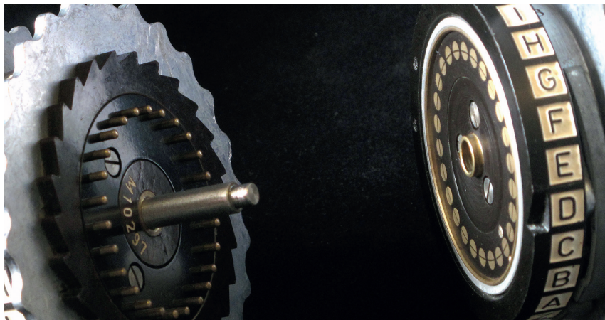
36 Schlüsselwalzen einer Marine-Enigma mit Buchstaben-Beschriftung
