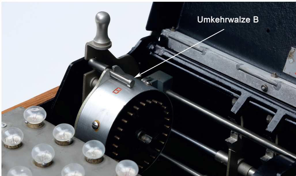
14 Rückschlag für die polnischen Mathematiker: die neue Umkehrwalze B
