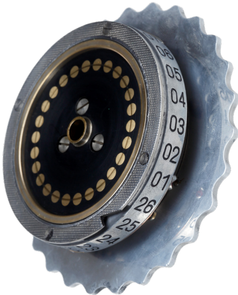
8 Schlüsselwalze mit Ring und Übertragskerbe
