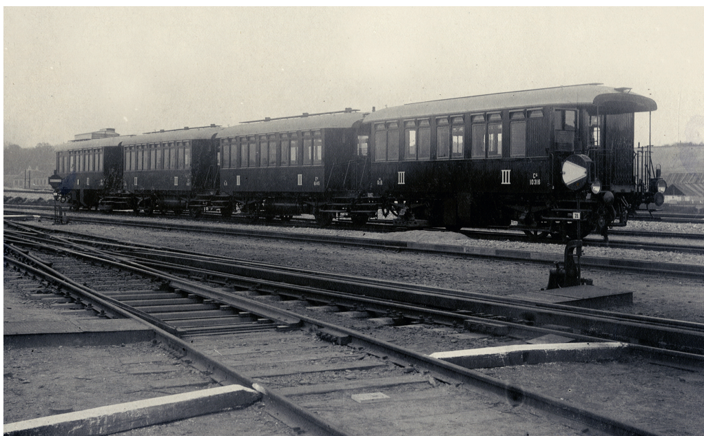
05-08: Elektrisch betriebener Zug während der Versuchsanordnung von Siemens & Halske, Versuchszug, elektrischer Probebetrieb – Wiener Stadtbahn, Aufnahme 1901–1903, EA-002554-18
