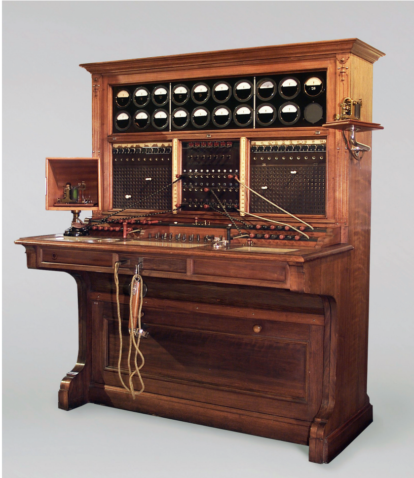
34 Telegrafvermittlungsschrank zur Verteilung eingehender Telegramme an freie Telegrafplätze.
