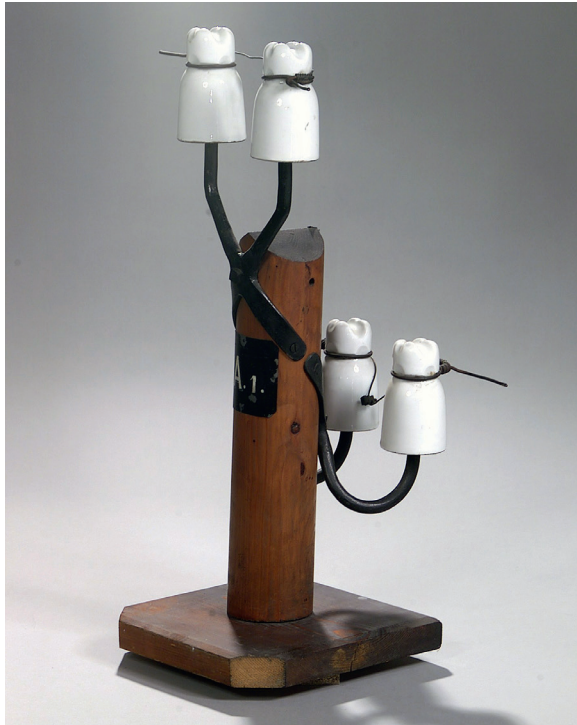
5 Isolatoren aus Porzellan halten den Strom in der Telegrafenerleitung.
