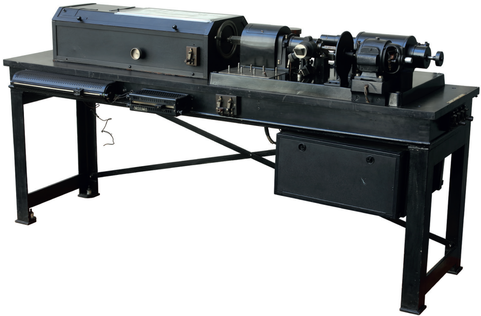
51 Der Bildtelegraf von Karolus ermöglicht es, Bilder in ansprechender Qualität zu übermitteln.
