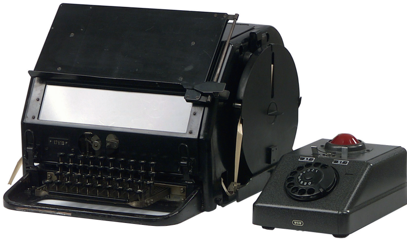
53 Das Fernschaltgerät erlaubt es, den gewünschten Fernschreibteilnehmer per Wählscheibe direkt anzuwählen.
