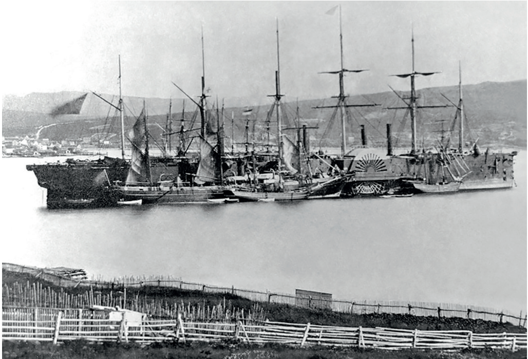
16 Das Kabelgeschiff Great Eastern ist groß genug, um das gesamte Transatlantikkabel zu transportieren.
