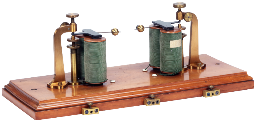
10 Mithilfe des Translators von Matzenauer können eingehende Telegramme automatisch weitergeleitet werden.
