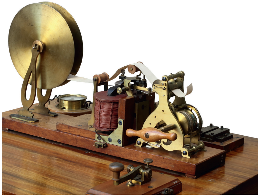
9 Der Prototyp – der Morsetelegraphenapparat nach Vail.
