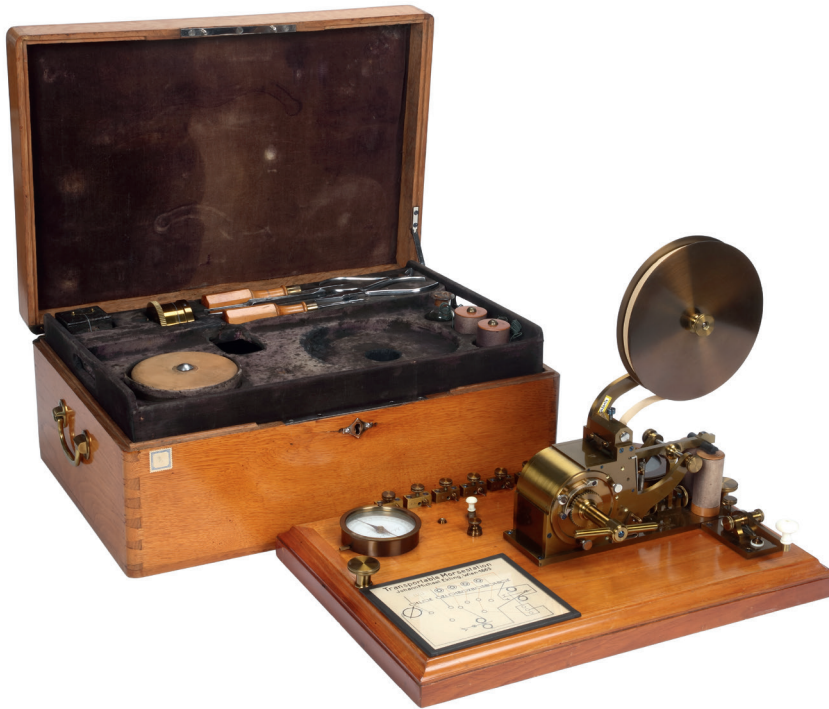
6 Mit dem transportablen Telegrafen kann an jeder Stelle einer Telegrafeneileitung eine Verbindung hergestellt werden.
