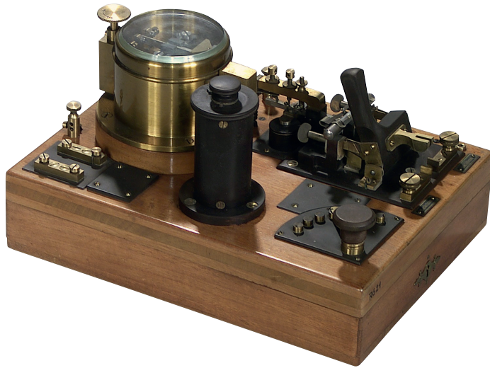
37 Der Kohärer registriert eintreffende Funkwellen mittels Metallspänen.
