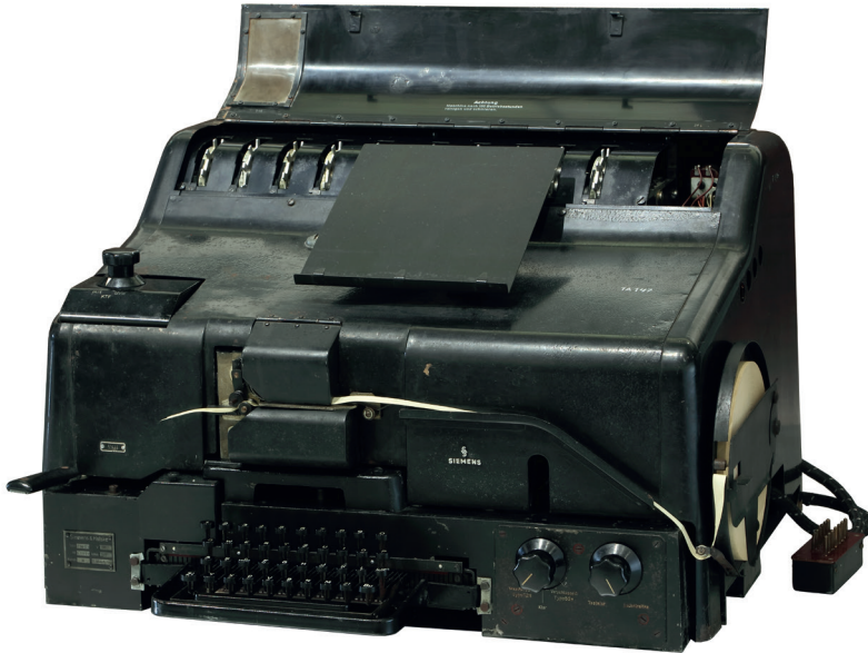
60 Der Geheimschreiber dient zur Verschlüsselung hochrangiger Fernschreibkorrespondenz.
